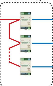
MODBUS интерфейсния модул позволява управление на климатичните системи с или без необходимостта от свързване на кабелни дистанционни управления.
